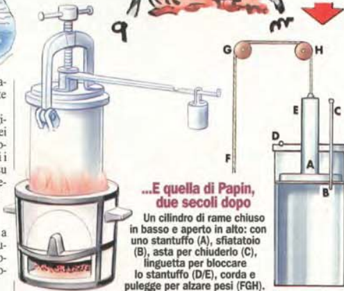
Leonardo 2: la pentola a vapore... Uno schizzo preso da Leonardo che prefigura il primo motore a vapore: un cilindro e uno stantuffo azionato dal vapore.
